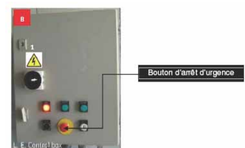
BOUTON D'ARRÊT D'URGENCE SUR LA BOITE DE CONTRÔLE DE LA NACELLE
